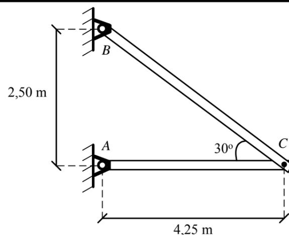
A figura mostra duas barras  $AC$  e  $BC$  que suportam, em equilíbrio, uma força  $\mathbf{F}$  aplicada no ponto  $C$ . Para que os esforços nas barras  $AC$  e  $BC$  sejam, respectivamente,  $36 \text{ N}$  (compressão) e  $160 \text{ N}$  (tração), o valor e o sentido das componentes vertical e horizontal da força  $\mathbf{F}$  devem ser:
