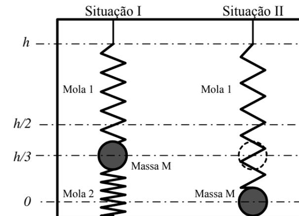
Na Situação I da figura, em equilíbrio estático, a Massa M, presa a molas idênticas, está a uma altura  $h/3$ . Na Situação II, a mola inferior é subitamente retirada. As molas, em repouso, têm comprimento  $h/2$ . O módulo da velocidade da Massa M na iminência de tocar o solo na Situação II é:
