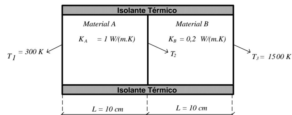
A figura composta por dois materiais sólidos diferentes A e B, apresenta um processo de condução de calor, cujas temperaturas não variam com o tempo. É correto afirmar que a temperatura  $T_2$  da interface desses materiais, em kelvins, é:
