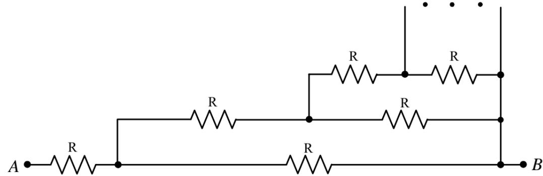
Sabendo que todos os resistores da malha infinita da figura têm resistência  $R$ , a resistência equivalente entre  $A$  e  $B$  é:
