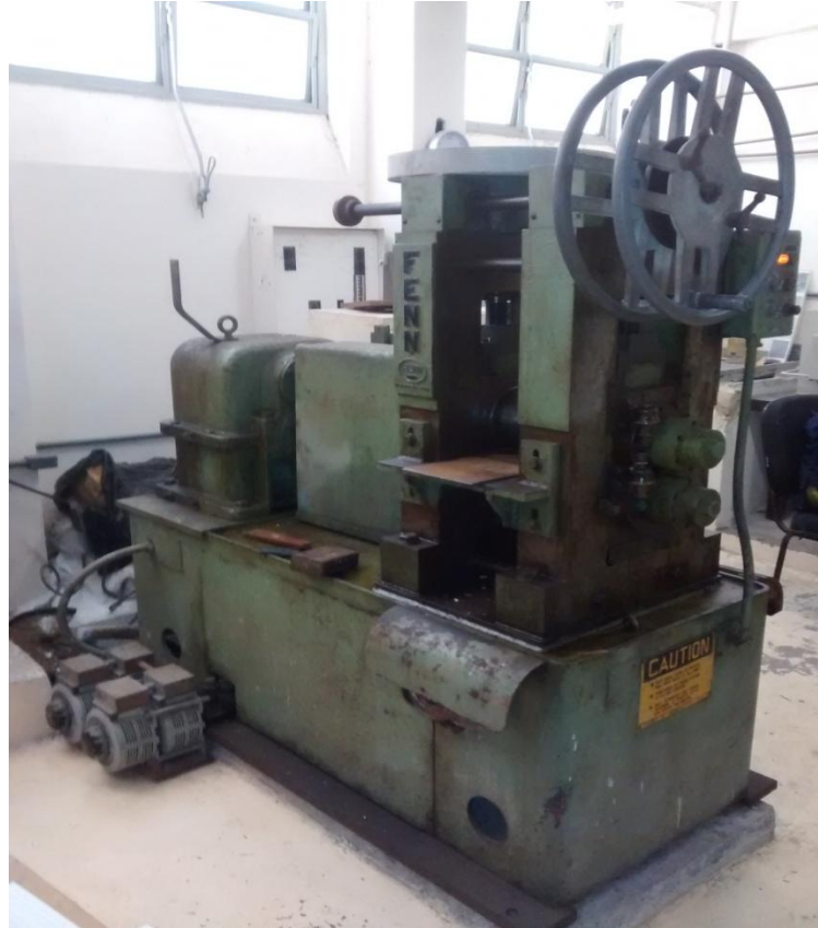
Fig 9: Laminador FENN do Laboratório de Processamento Mecânico.
