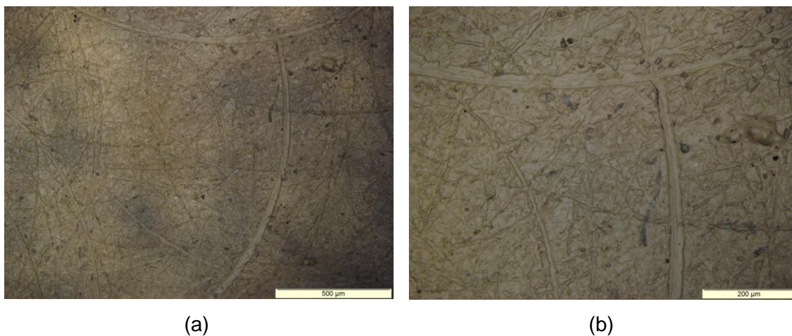
FIG. 4.27: Fotomicrografias, por microscopia óptica, da membrana de implante mamário liso após 125 kGy de radiação gama, com ampliação de: (a) 100X; (b) 200X.
