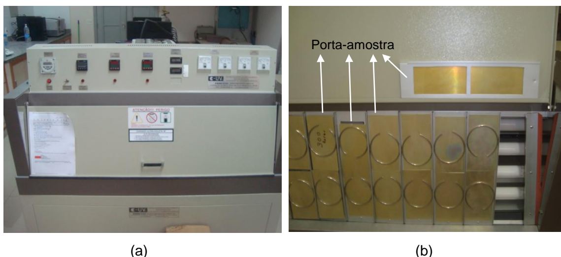
FIG. 3.2: Equipamento C-UV Sistema Acelerado de Envelhecimento para não Metálicos da COMEXIM para radiação UV-B: (a) com a porta fechada; (b) com a porta aberta.
