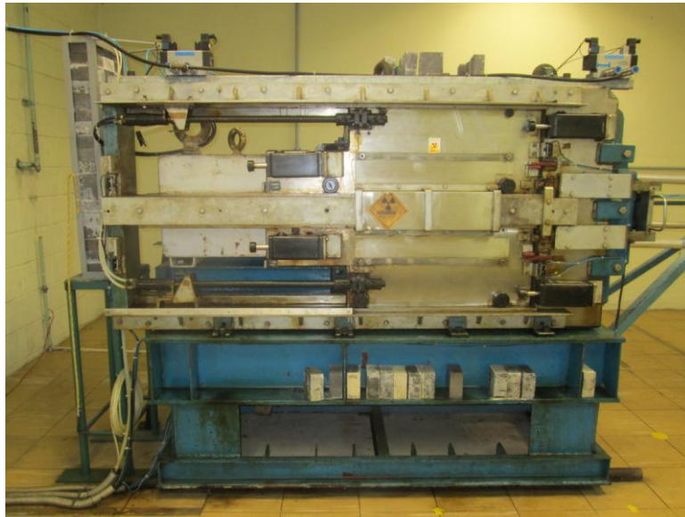
FIG. 3.4: Irradiador Gama de Pesquisa com fonte ^{137}\text{Cs} do CTEEx.
