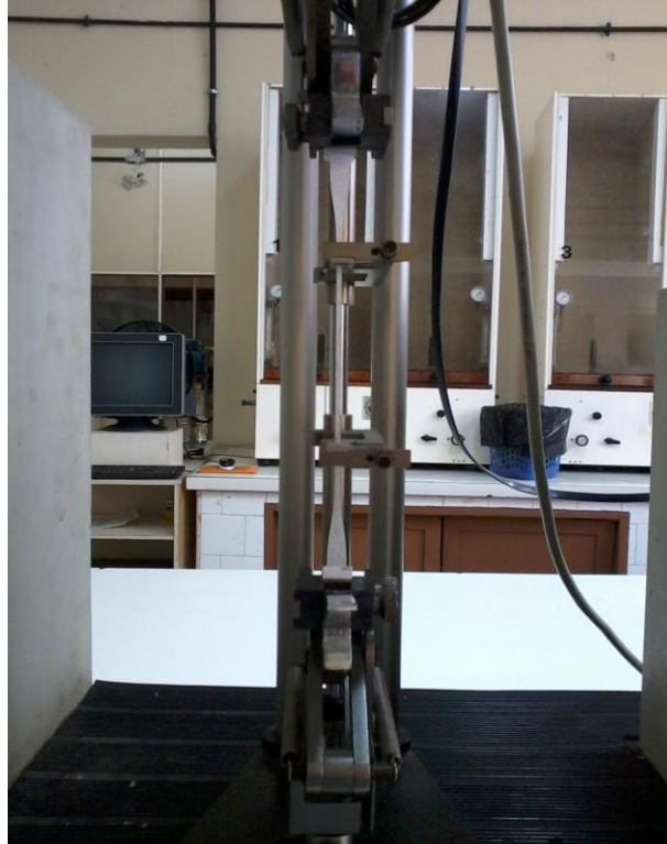
FIG. 3.7: Ensaio de tração do corpo-de-prova da membrana de implante mamário de silicone, estirado na Máquina Universal de Ensaio.
