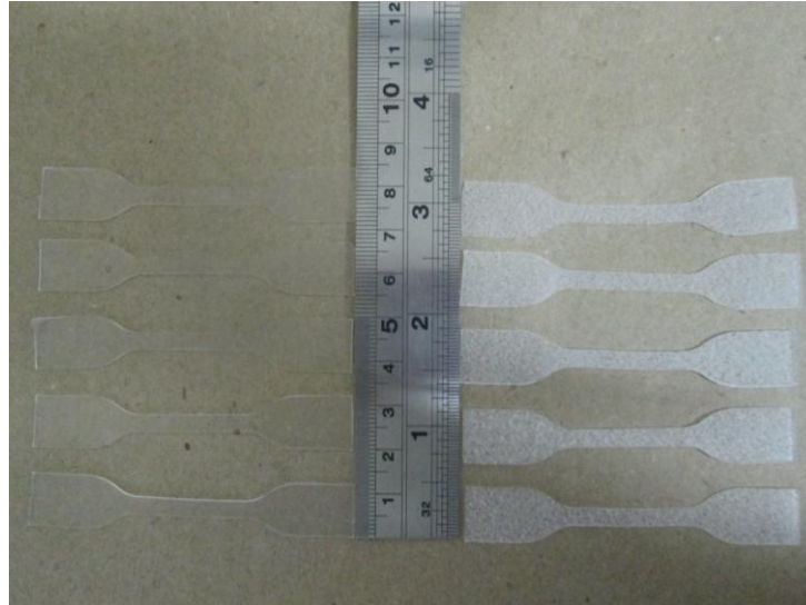
FIG. 3.1: Da esquerda para a direita, corpos-de-prova de implante mamário liso e texturizado confeccionados para o ensaio de tração.
