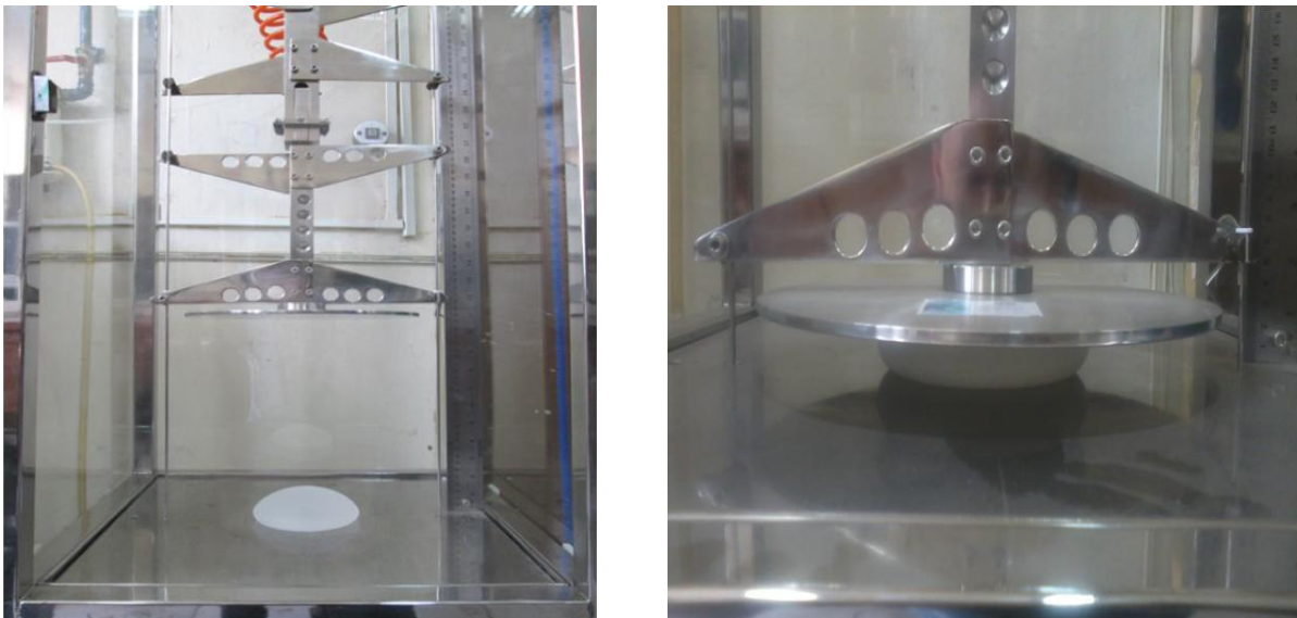
FIG. 3.8: Força de impacto aplicada ao implante mamário através da queda livre da massa de 4,4 kg.
