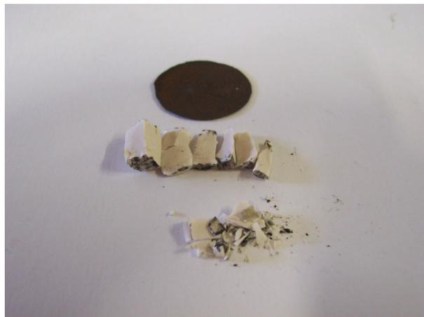
FIG.5.24 Amostra fragmentada na condição sem confinamento e com modelador.
