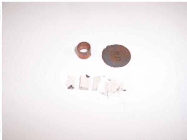
FIG.5.28 Amostra de AD92 fragmentada com confinamento e modelador.
