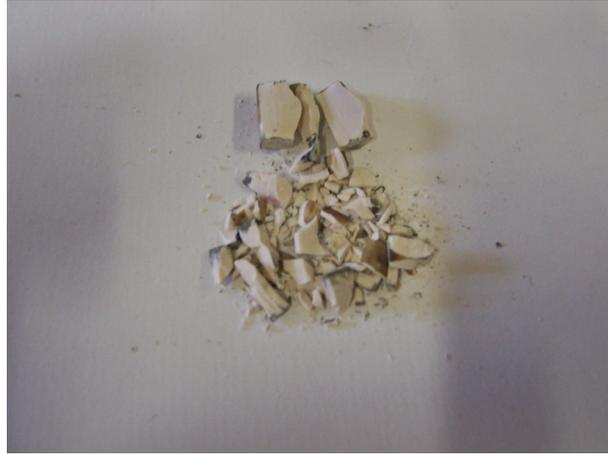
FIG.5.16 Amostra de AD92 fragmentada.
