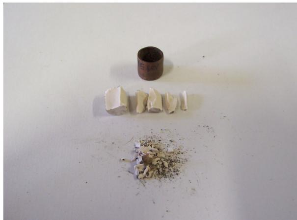
FIG.5.20 Amostra fragmentada, na situação com confinamento e sem modelador.
