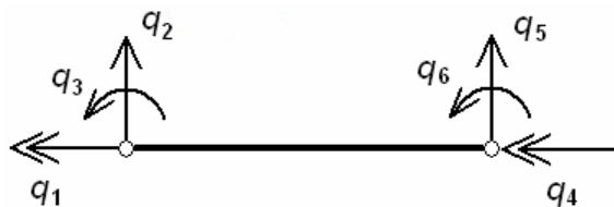
FIG. 3.30 Elemento de grelha, com a numeração dos GDL para o problema.
