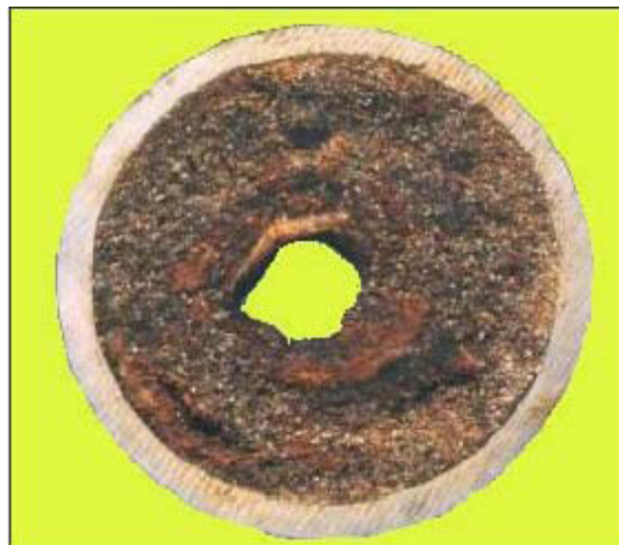
FIG. 2.2 Bloqueio de linha por deposição de parafina.
