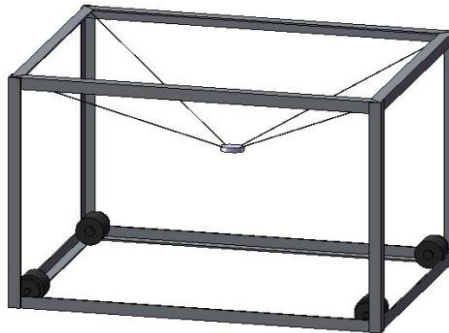
FIG. 1.2 - Manipulador paralelo acionado por cabos
