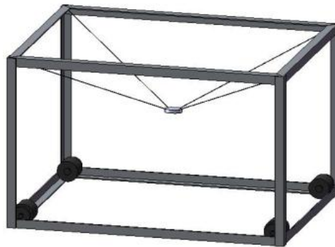
FIG. 2.1 - Manipulador incompleto de cinemática restrita
