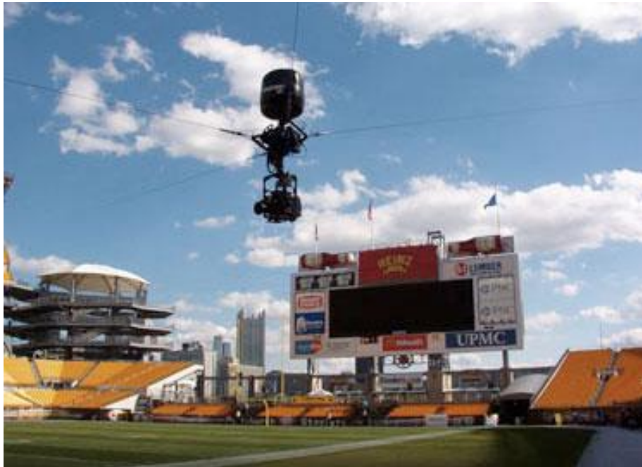
FIG. 1.6 - Posicionamento de câmeras em grandes espaços ( http://upload.wikimedia.org/wikipedia/commons/1/14/Skycam.jpg )
