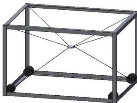
FIG. 2.2 - Manipulador completo de cinemática restrita
