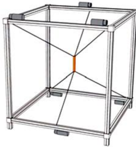
FIG. 2.8 - 2R3T: Movimento espacial de uma barra
