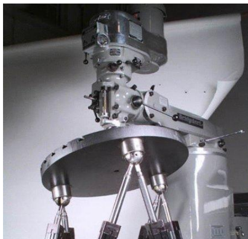
FIG. 1.5 - Processos de usinagem de peças com manipuladores paralelos ( http://www.eng.nus.edu.sg/EResnews/0602/images/rd_12a.jpg )
