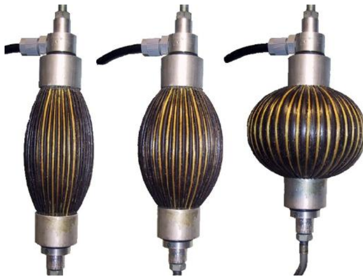
FIG.5.2 - Contração do músculo pneumático - " www.gizmodo.com.br (18/04/2013)"
