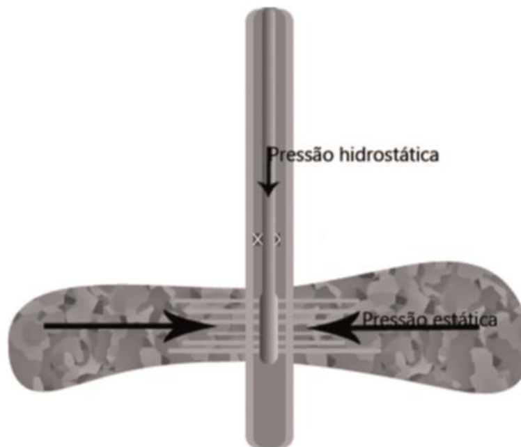
FIG. 2.12 Método Sub Pressão (Underbalance) (VIEIRA et al, 2011).
