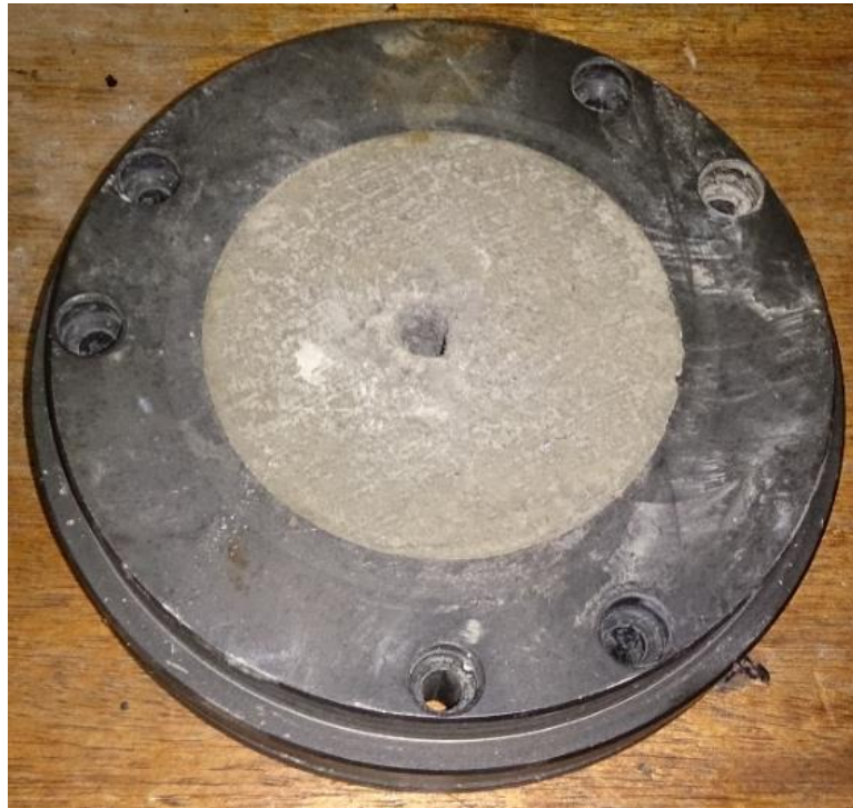
FIG. 4.11 Peça com cimento perfurado ao meio e aço em volta.
