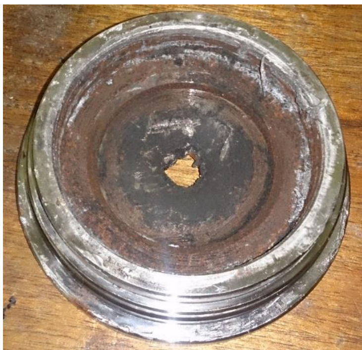
FIG. 4.14 Placa de aço simulando a saída do canhão de aço perfurada após experimento.
