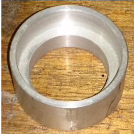
FIG. 4.7 Peça de encaixe da carga para distanciamento ótimo até os alvos (“stand-off”).
