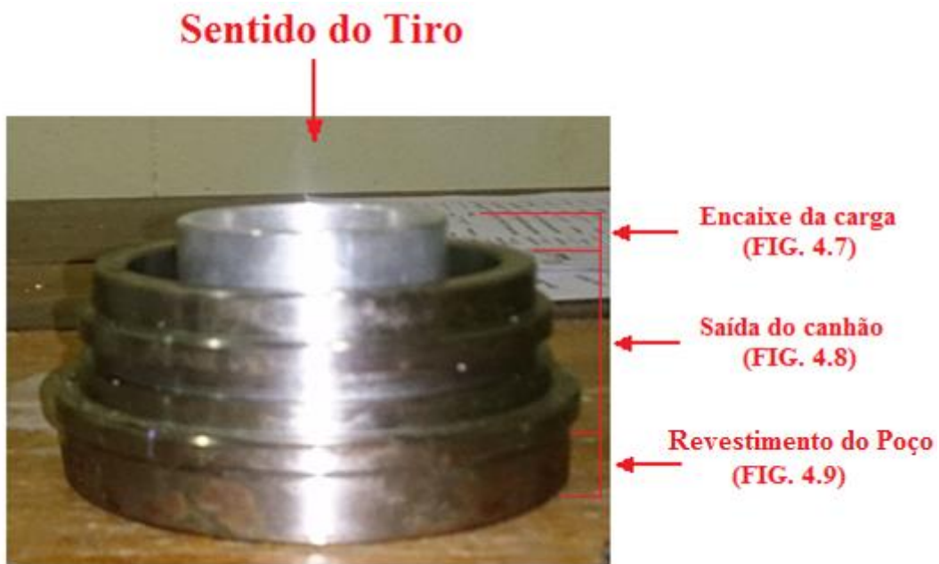
FIG. 4.10 Montagem do conjunto: acima é o encaixe da carga para distanciamento ótimo até os alvos, no meio o a saída do canhão e abaixo o revestimento do poço.
