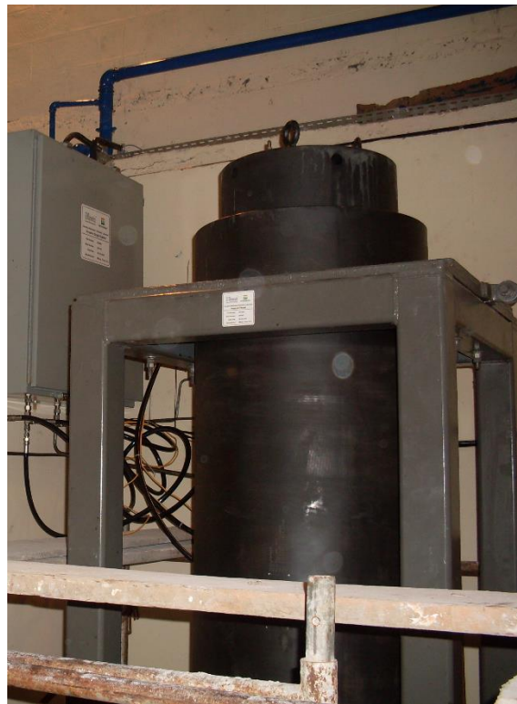
FIG. 4.4 Vaso de pressão usado no experimento de canhoneio.
