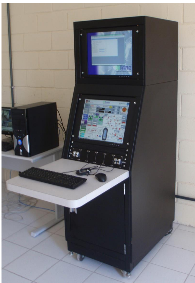
FIG. 4.5 Equipamento de controle e acionamento de canhoneio.
