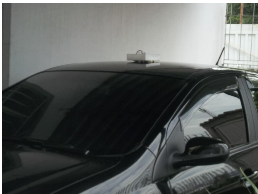
FIG. 7.7 – Veículo real com a caixa dos sensores.
