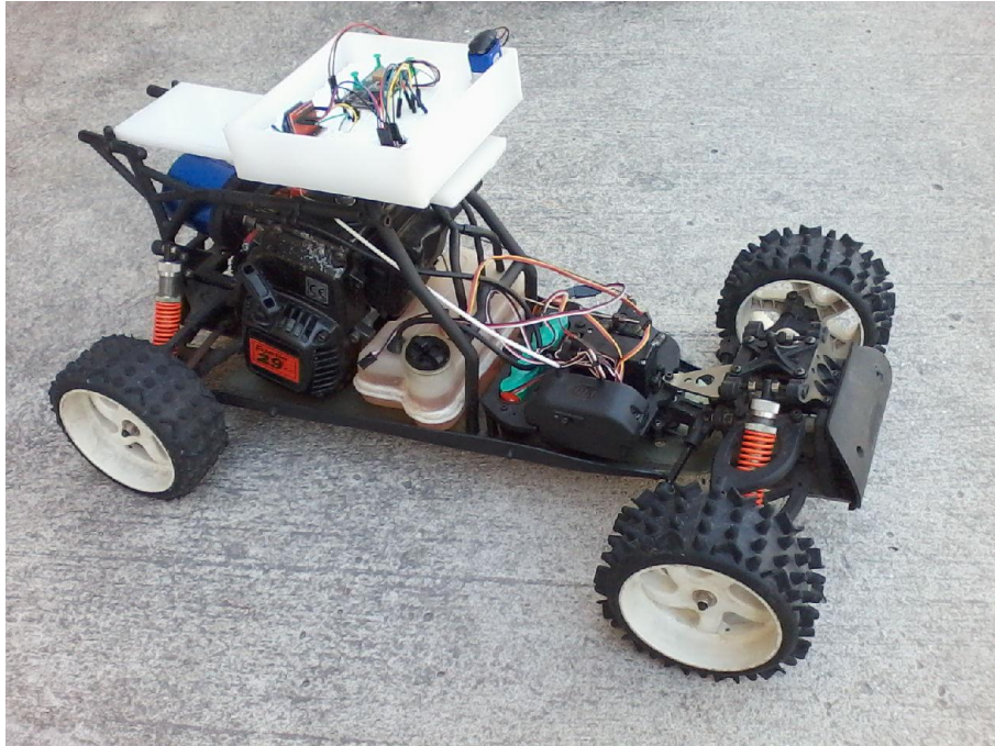
FIG. 7.5 – Baja acoplado com a caixa dos sensores
