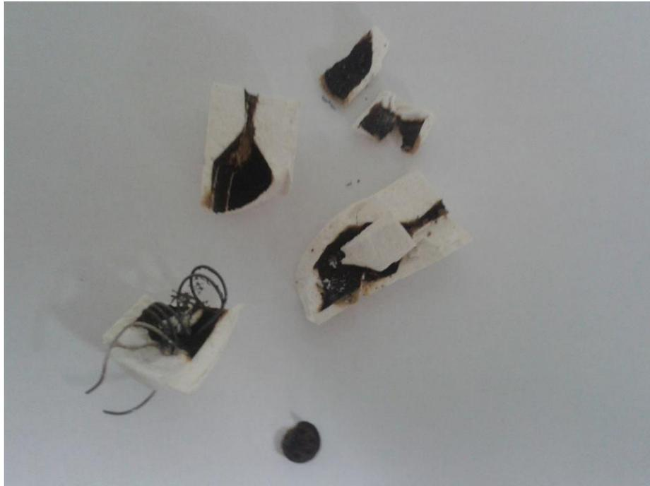
FIG. 5.21: Conjunto micropropulsor após a queima.
