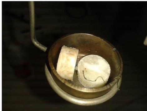
FIG. 3.43: Amostra sem queima após a análise.
