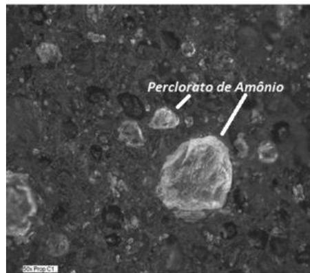
FIG. 3.46: Imagem da amostra de propelente (Fonte: MANEA, *et al.*, 2014).
