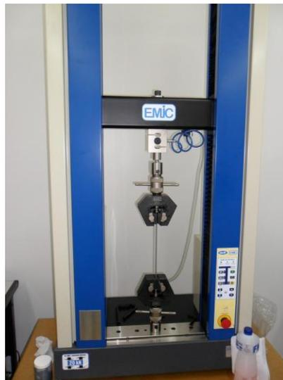
FIG.4.6 : Máquina universal usada para o ensaio de flexão.
