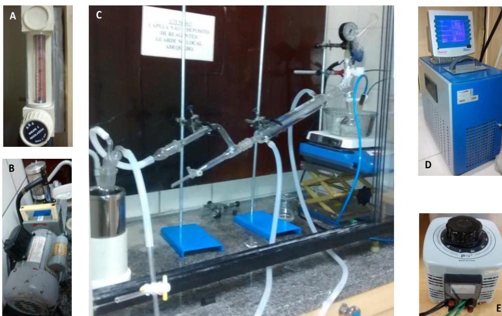
FIG. 3.2: Unidade experimental - (A) Elemento de controle da vazão de nitrogênio; (B) Bomba à vácuo; (C) Reator, banho térmico com agitação, elemento de controle de pressão, Condensador; (D) Banho termostático; (E) Voltímetro.
