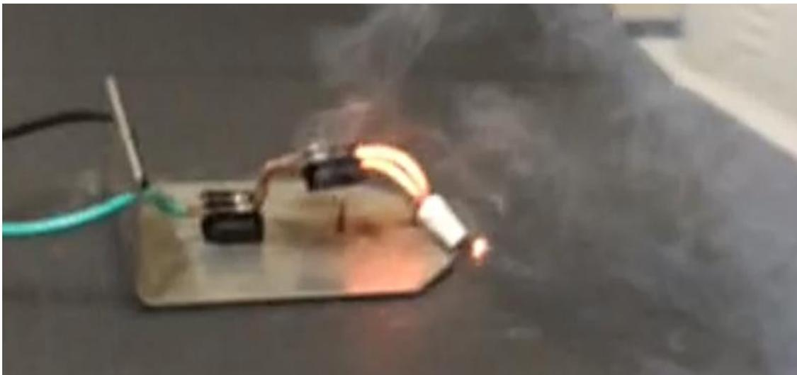
FIG. 5.18: Queima constante do propelente com liberação de gases.
