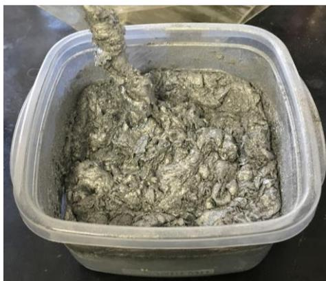
Figura 4.2 – Mistura de resina epóxi e pó de alumínio
