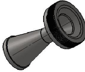
Figura 1.2 - Perspectiva isométrica da tubeira
