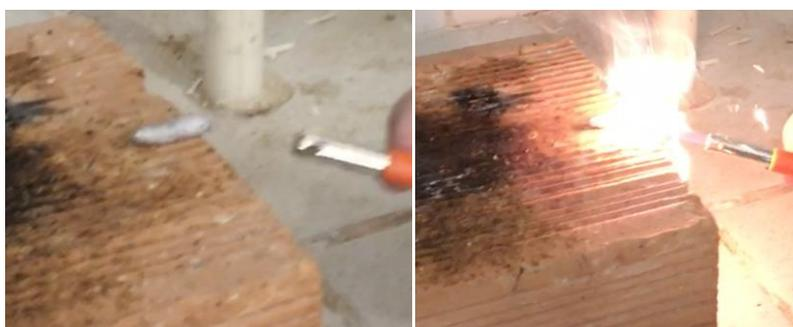
Figura 4.6 - Teste de acionamento da carga de iniciação
