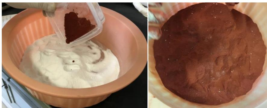
Figura 4.3 - Adição de óxido de ferro para evidenciar os aglomerados brancos
