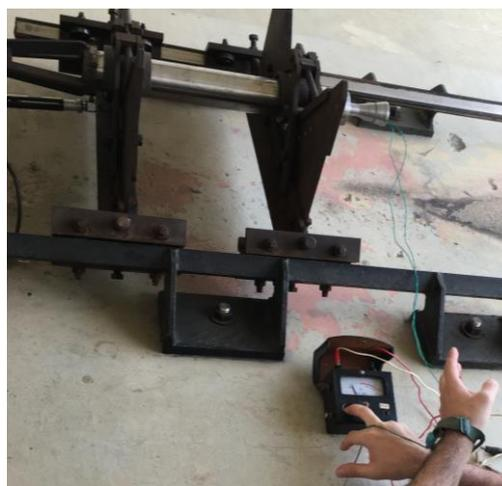
Figura 4.20 - Verificação da resistência do “skib”
