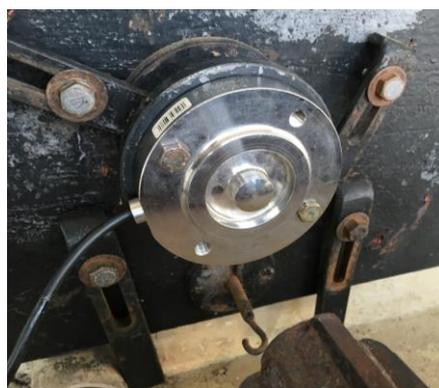
Figura 4.18 – Célula de carga
