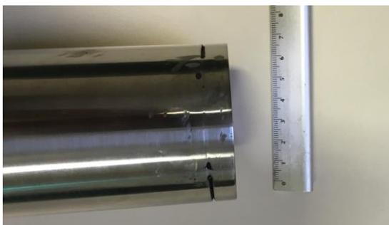
Figura 4.9 - Ponto de solda entre a tampa e o tubo motor
