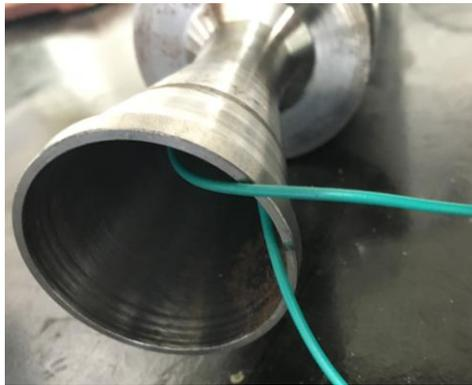
Figura 4.14 - Saída do fio pela tubeira e ligado à fonte externa
