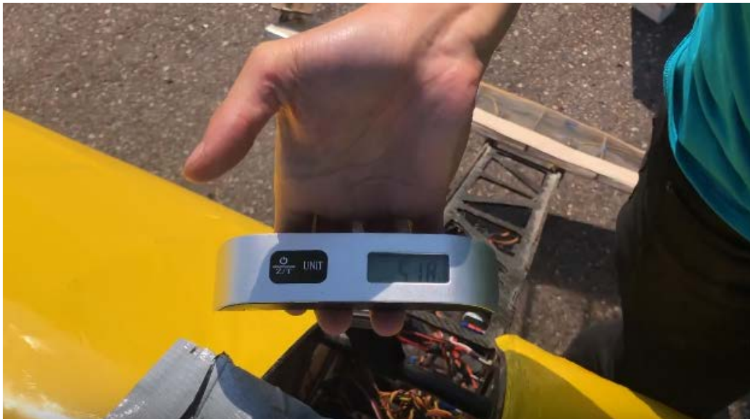
Figura 74: Medida do peso vazio do avião.
