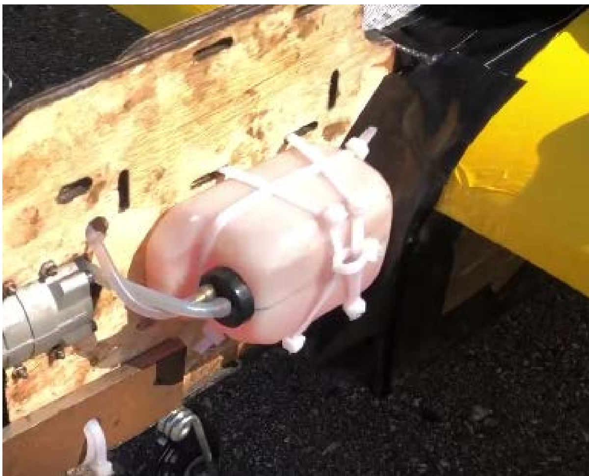
Figura 75: Verificação do nível de combustível.
