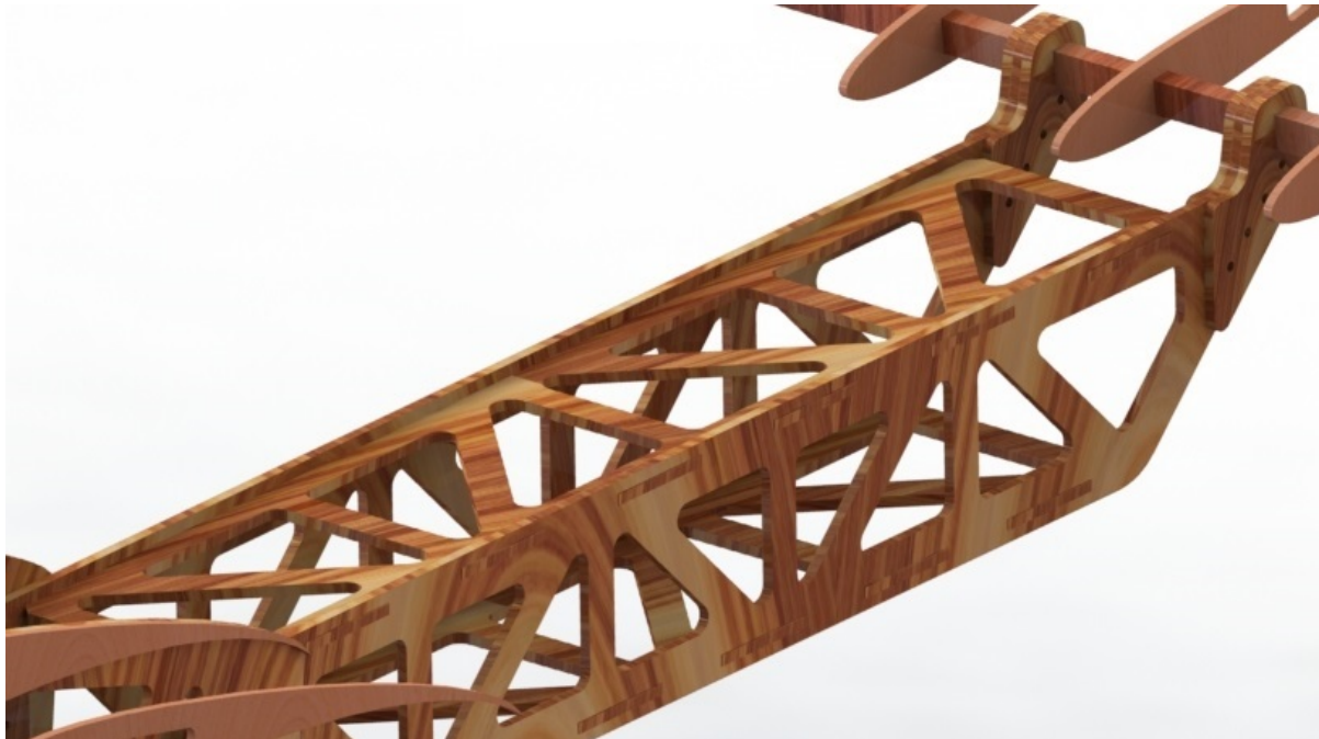
Figura 6: Tailboom projetado para reduzir torção.
