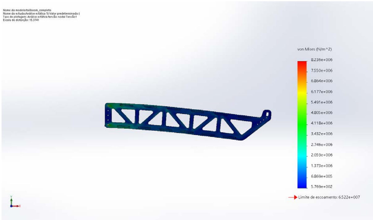
Figura 44: Tensões no tailboom.
