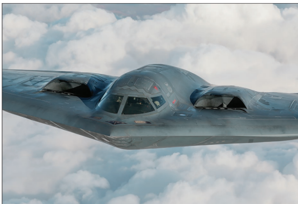
Figura 2.3: As entradas do motor do lado de cima de um bombardeiro B-2, que direcionam o ar para os motores enterrados, são claramente visíveis nesta fotografia. O uso de motores enterrados e entradas stealth especialmente configuradas provaram contra-medidas efetivas contra sensores IR [9].
