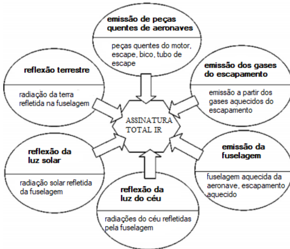
Figura 2.6: Distribuição e detalhamento da assinatura IR de uma aeronave [1].
