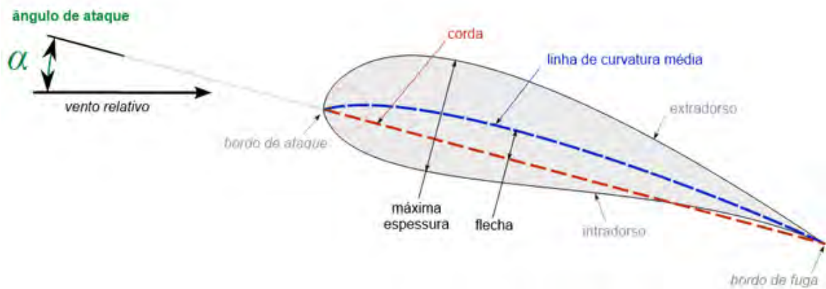
Figura 9 – Parâmetros usados para descrever um aerofólio (4)
