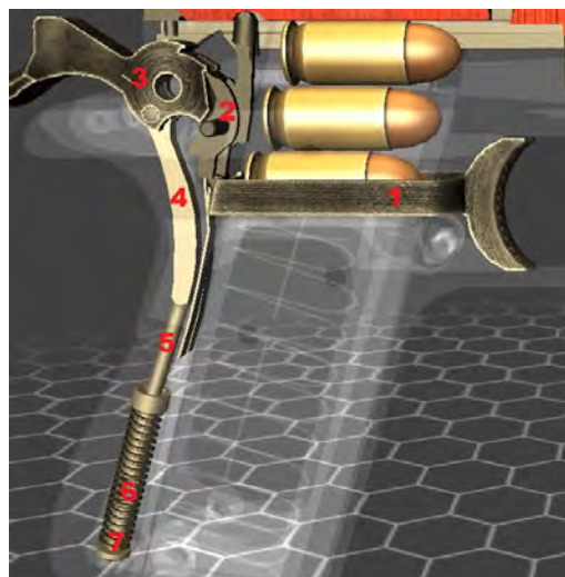
Figura 21 – Componentes do mecanismo de disparo: 1- Gatilho 2- Noz de armar e alavanca de disparo 3- Cão 4- Alavanca de armar 5- Apoio superior 6- Mola 7- Apoio inferior
