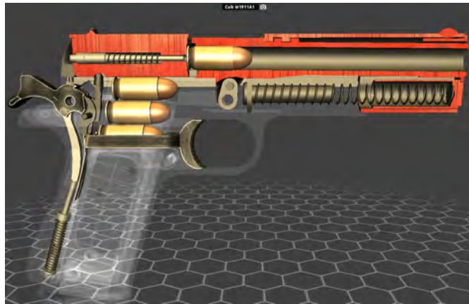
Figura 20 – Vista em corte da parte interna
